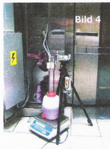
Bild 4 Messeinrichtung/ Kraftstoffwaage u. Behälter
