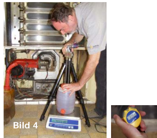
Messeinrichtung/ Kraftstoffwaage u. Behälter
